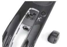
●グリップ部は反時計回りに回すと外れます。非常に堅く固定されていますので、傷つけないように周囲に気をつけて外してください。
