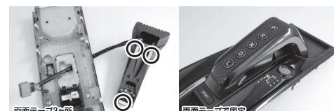
11 シフトスイッチ裏面に固定プレートを取り付けます。
