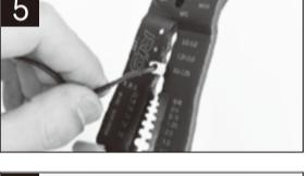
電工ペンチまたはプライヤーを使用し、圧着します。コードと端子がずれないよう注意しながら圧着してください。
