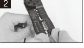
電工ペンチを使用し、コード先端の被覆を剥ぎ、芯線を出します。
