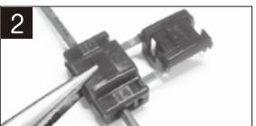
配線がズレないよう、気を付けながら電工ペンチまたはプライヤーで圧着します。
