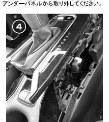
センターコンソール前側(シフト部分)を取り外します。
