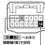
3(薄紫)へ本体の制御線(紫)を接続 14(黄色)へ本体の制御線(橙)を接続
