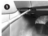
運転席下のアンダーパネルを取り外します。(ネジ2本)
