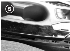
センターコンソール後側(ドリンクホルダー部分)を取り外します。
