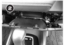
センターコンソール前のパネルを取り外します。※右下半部分が運転席下アンダーパネルのネジで一緒に固定されているので、必ず運転席下アンダーパネルから取り外してください。
